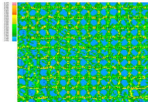
Figure 2 (d) Fold pattern at 650 m offset.
